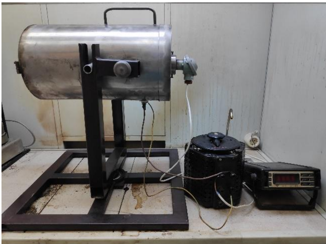
1 сурет - инертті атмосферада өсімдік шикізатын карбонизациялауға арналған қондырғы
