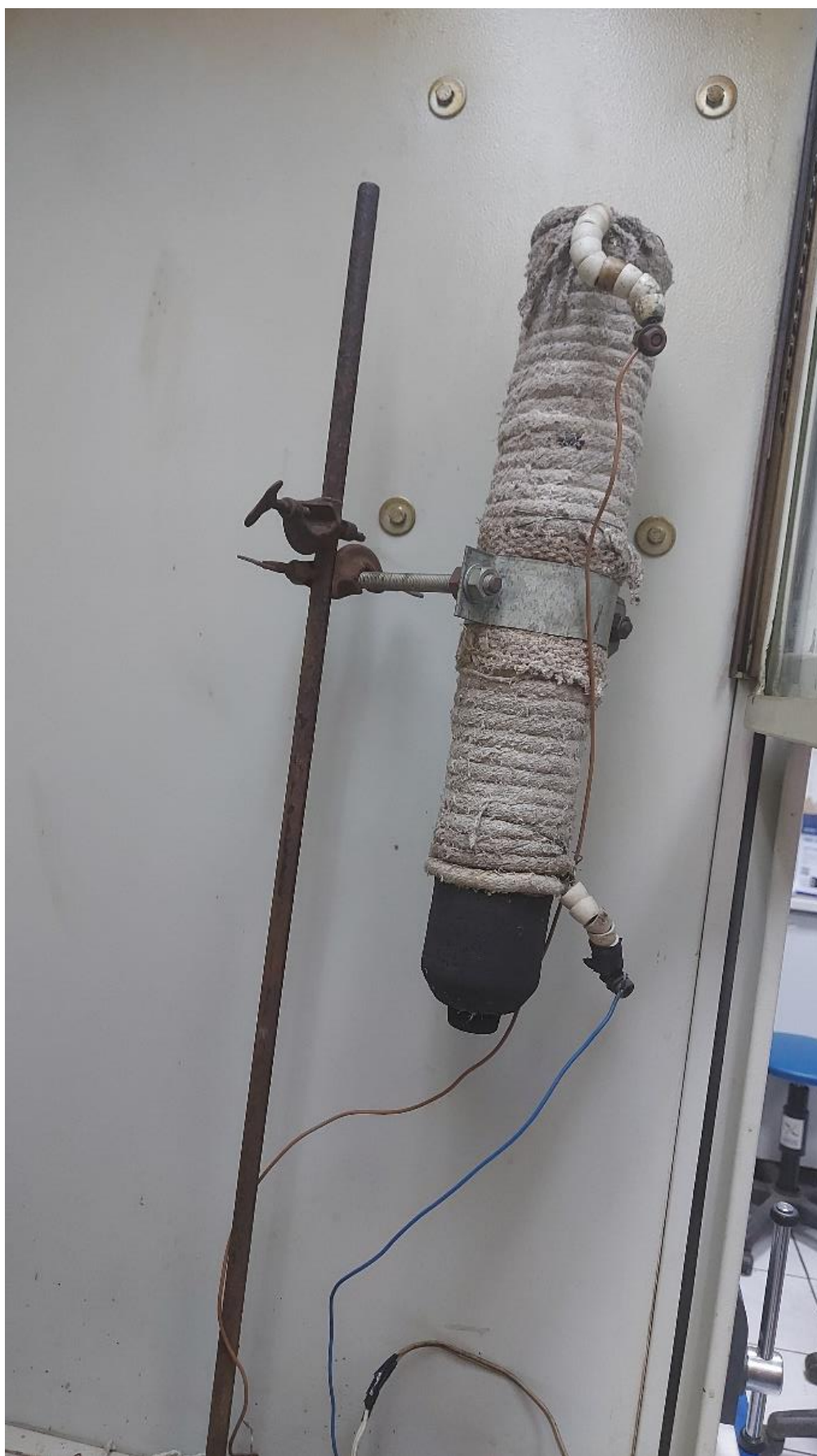
2 сурет - қызып кеткен су буымен белсендіруге арналған қондырғы
